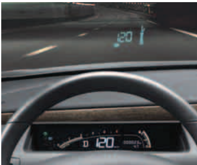
Una particolarità della C6 è costituita dal sistema che proietta sul parabrezza l'indicazione digitale della velocità.
